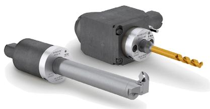
Les douilles de serrage **ETP HYDRO-FIX<sup>®</sup>** sont excellentes pour les barres d'alésage pour le tournage intérieur et extérieur ainsi que pour les porte-outils entraînés. Avec le système de fixation à une vis, elles sont rapides et faciles à manipuler. Le serrage est uniforme autour de l'outil et donc la durée de vie de l'outil est améliorée. Le système de serrage absorbe et réduit les vibrations, améliore la qualité de la surface et, surtout, augmente votre productivité !
