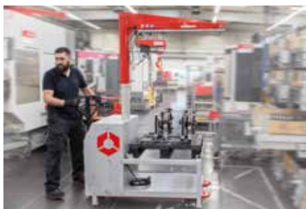
Spannmittel gesichert zur Maschine bewegen mit dem Rüstmobil oder Rollwagen.
