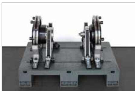
Palette mit flexiblen Halterungen für die Spannmittel inkl. 2 Aufsatzrahmen und Deckel.
