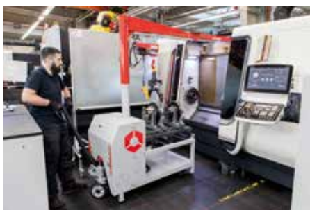
Alle Spannmittel sind später beim Rüstvorgang griffbereit.
